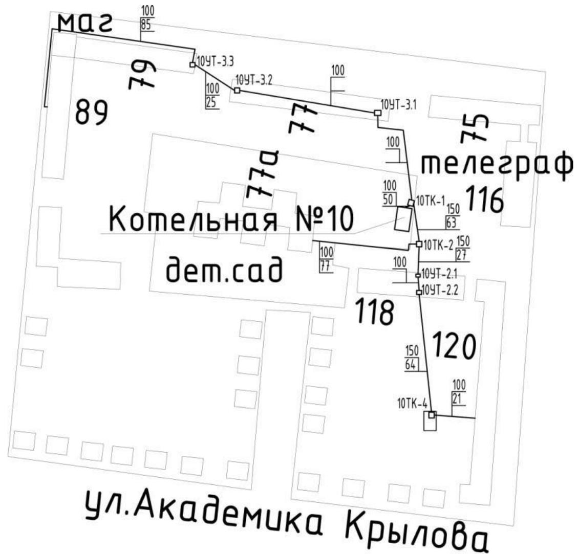
Рисунок О1.7 Принципиальная схема мест расположения источников тепловой энергии (Котельная №10)
