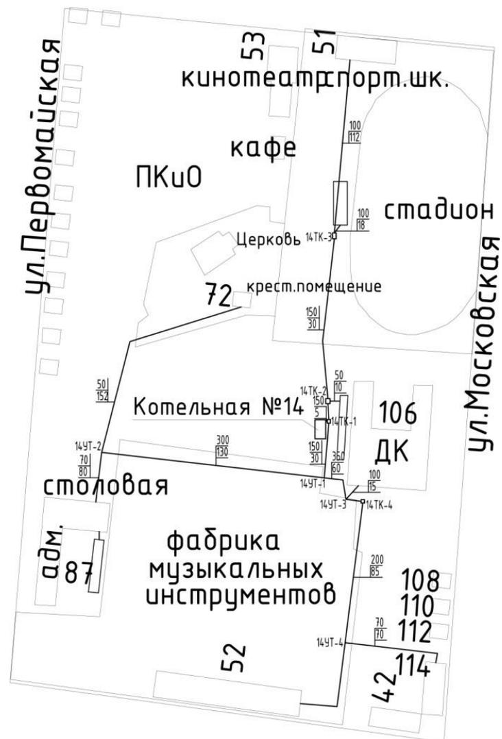
Рисунок О1.10 Принципиальная схема мест расположения источников тепловой энергии (Котельная №14)
