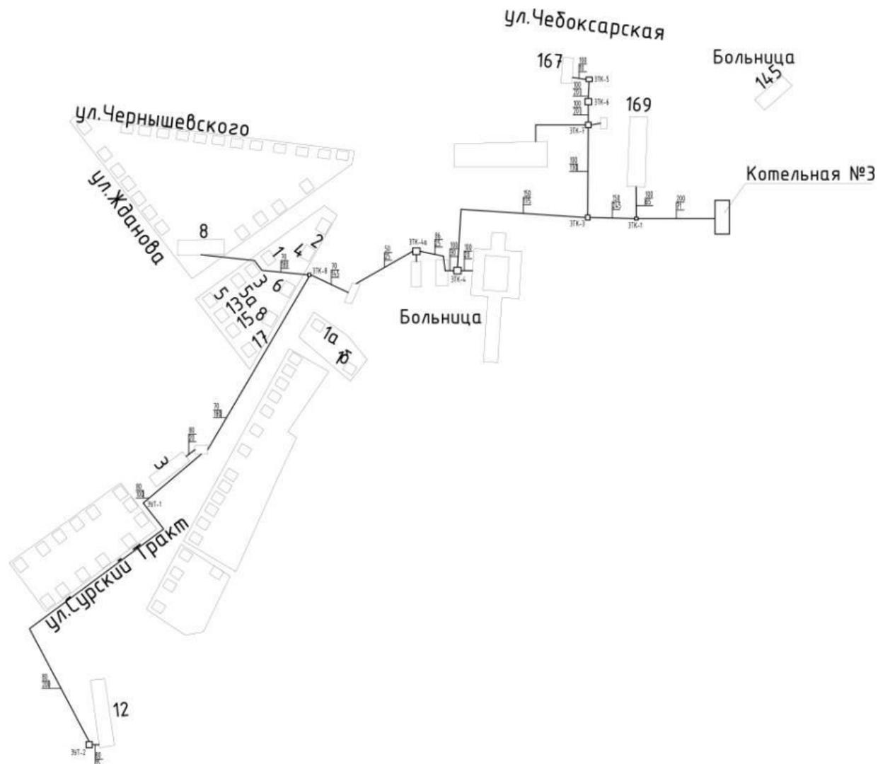
Рисунок О1.3 Принципиальная схема мест расположения источников тепловой энергии (Котельная №3)
